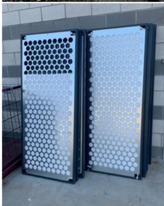
Innenseite der Schalhauben Isolation die zusätzlich mit einem Lochblech gegen Verschiebung gesichert ist.
