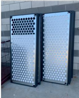
Innenseite der Schalhauben Isolation die zusätzlich mit einem Lochblech gegen Verschiebung gesichert ist.
